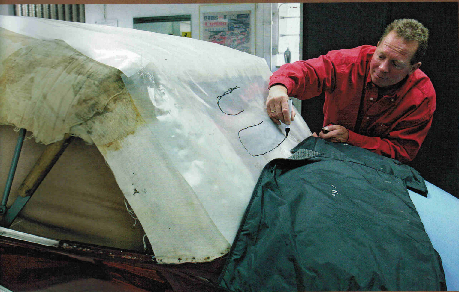
Ook voor een nieuwe cabrioletkap kun je bij Van Lith terecht. Hier tekent Henk de contouren van een achterraut die in de kap van een Bugatti moet komen.
